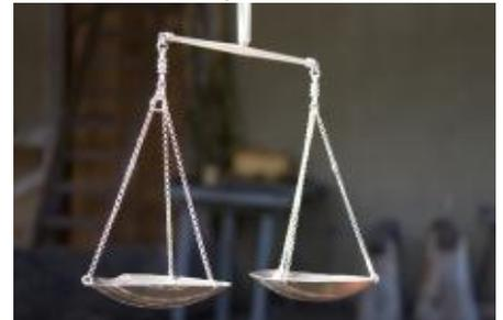
*Le plus simple des instruments de mesure nécessite une définition opérationnelle pour être correctement utilisé. Par exemple pour une balance à plateaux, on peut demander une double pesée (photo Hans Splinter, licence CC)*
